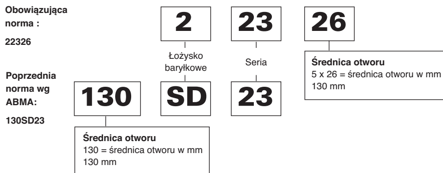
Rys. 24. Zależność oznaczeń pomiędzy normami ISO a ABMA.
