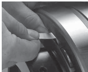
Rys. 18. Pomiar luzu wewnętrznego przed montażem.
